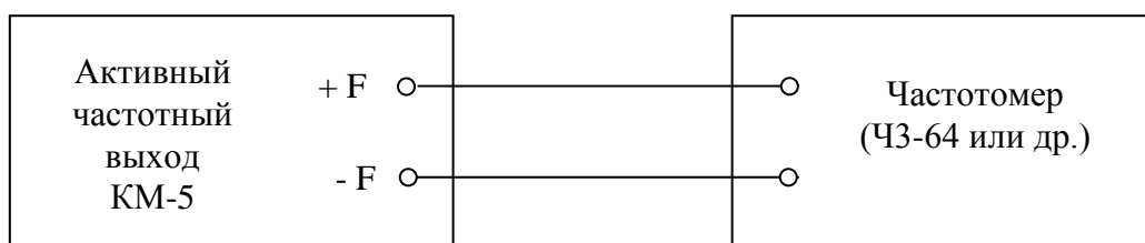
Рисунок А.6 — Схема подключения эталонного частотомера при поверке стандартных частотных выходов каналов КМ-5.
