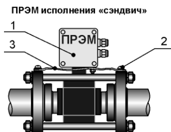
1 – электронный блок; 2 – винт М5; 3 – выравнивающий токопровод
