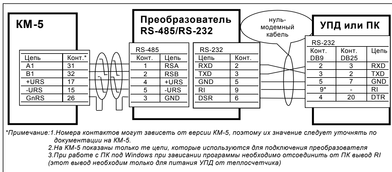
Рисунок 1— Схема подключения одиночного КМ-5 к ПК или УПД через преобразователь интерфейса для съема информации
